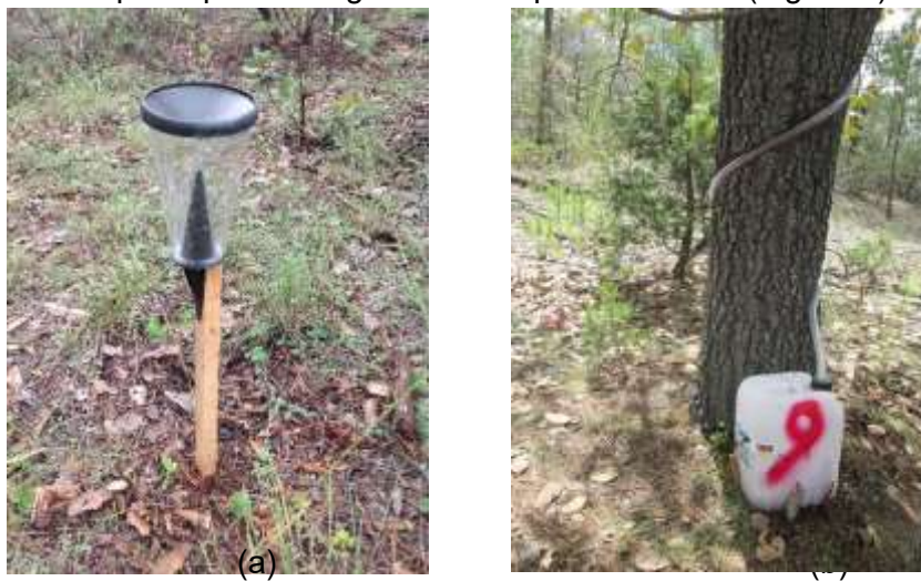
Figura 1. Pluviómetro (a) y aditamento para medir el escurrimiento fustal en árbol de encino (b).
