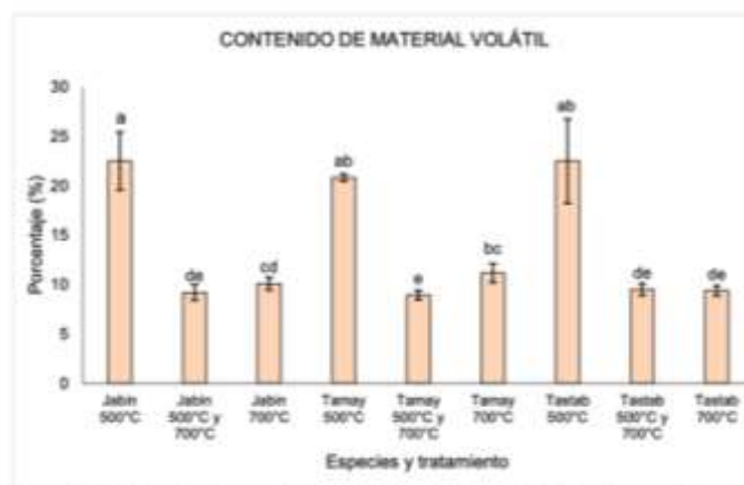
Figura 1. Contenido de material volátil del carbón vegetal elaborado por diferentes especies tropicales y diferentes tratamientos de pirólisis. Las letras diferentes en las barras de la gráfica significan la diferencia estadística entre los diferentes tratamientos.
